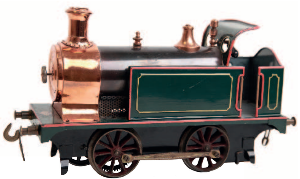
754 Bing S3 13761/3 Tenderlok mit Echtdampf betrieben. ‚Kraftlokomotive‘, Saisonneuheit von 1904. Mit oszillierendem Zylinder in Rauchkammer mit Zugknopf vor und zurück an Rauchkammertür. Spiritusbrenner, Dampfpeife. L32cm, Die Maschine wurde 1975 farblich restauriert. L32 € 450,00
