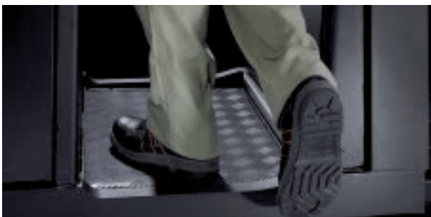
Die geringe Einstiegshöhe des TSE300 erleichtert den Ein- und Ausstieg. Die vibrationsgedämpfte Fahrerplattform reduziert Vibrationen und steigert damit den Fahrkomfort
