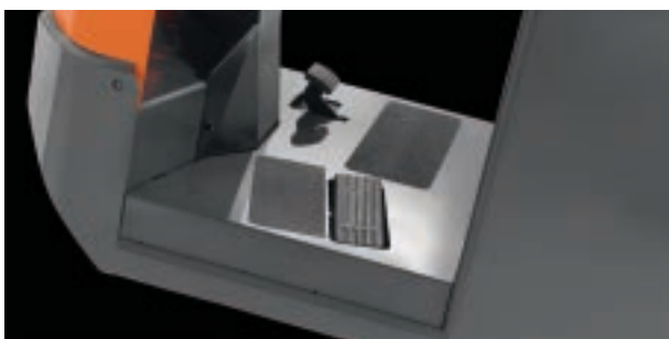
Die niedrige Einstiegshöhe der S-Serie erleichtert das Ein- und Aussteigen. Das OPS-System (Optimaler Personen-Schutz, linkes Pedal) ermöglicht die Bedienung des Schleppers nur, wenn der Fahrer in Fahrposition steht
