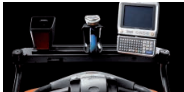
Der optionale E-Bar ermöglicht den Anbau von Zusatzausrüstungen wie Computern und Barcode-Lesegeräten
