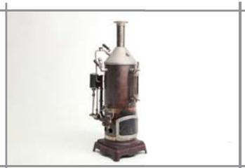
**3501** Bing stehende Dampfmaschine, Kessel 90mm, mit Dampfspeisepumpe, Brenner fehlt, H37cm, Z1-2
