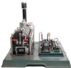
**3507** Märklin, liegende Dampfmaschine mit Dynamo. Kessel 80mm, Mit Manometer und Speisepumpe. Brenner fehlt. 37x37cm, Z1-2
