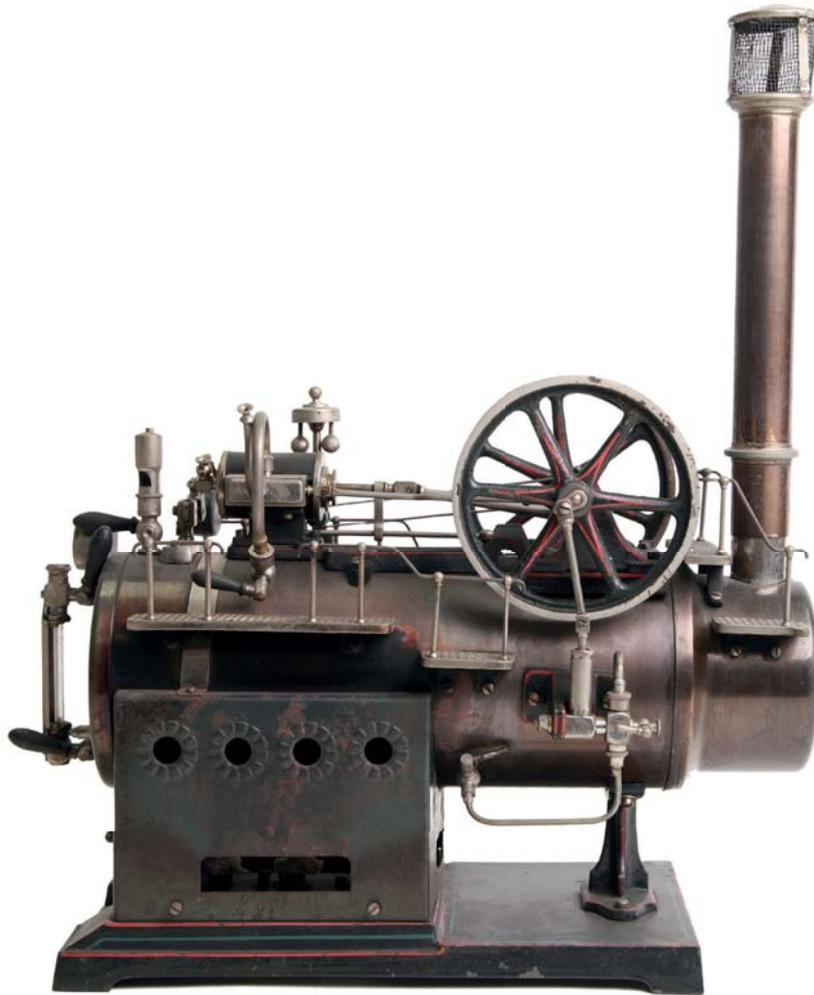
**3500** Falk grosses feststehendes Dampf-Lokomobil mit 2 Schwungräder, Kesseldurchmesser 11cm, Wasserstandsglas, Manometer und Dampfspeisepumpe. 35x45cm, Z1-2
