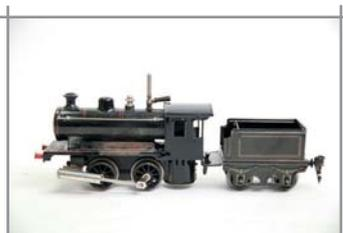
**8127** Märklin S 0, R4030 Spirituslok mit Tender, Echtdampf, oszillierende Zylinder, L28cm, Z2-
