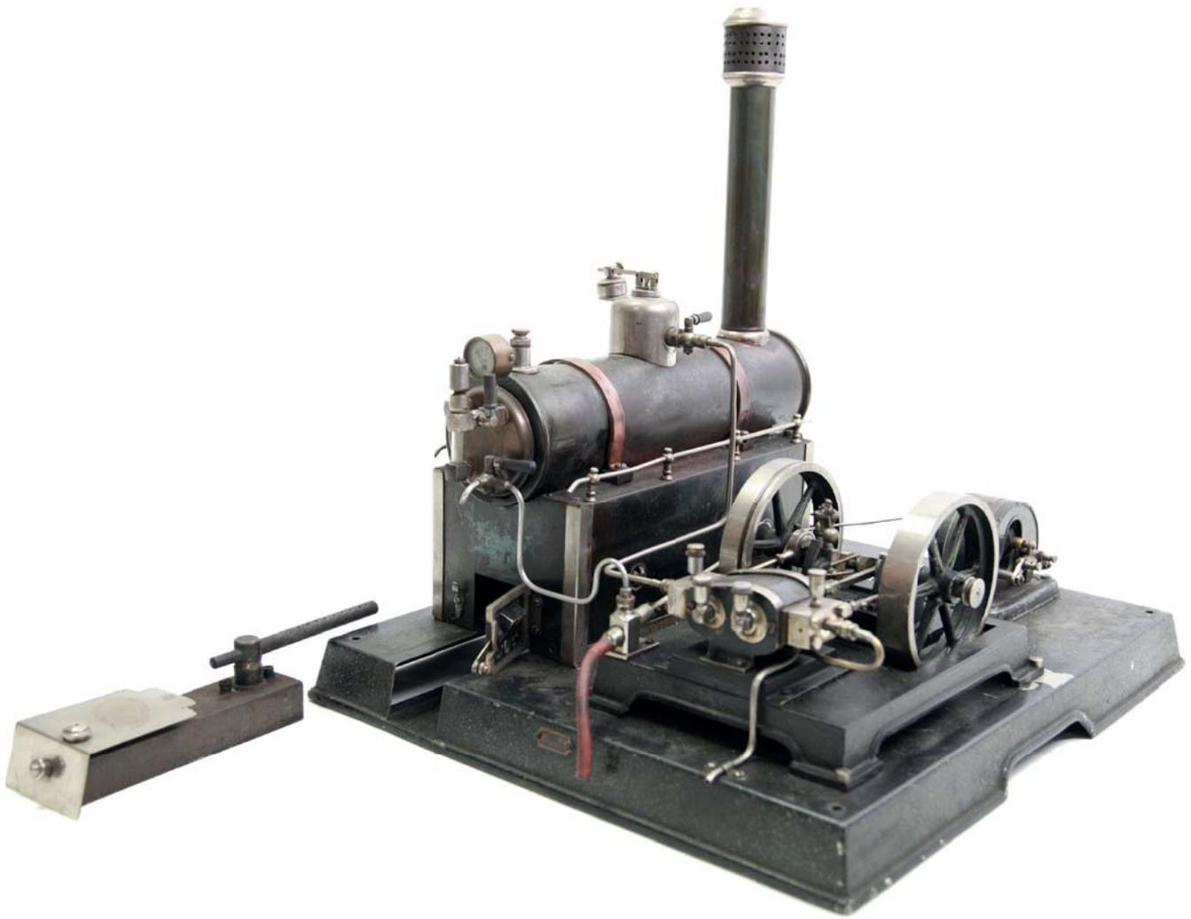
**8012** Märklin, 4158 /7 Dampfmaschine mit Dynamo, Compound Anordnung, mit seltenem Langröhren Brenner, Manometer und Sicherheitsventil und Speisepumpe, 42x37cm, Z2+
