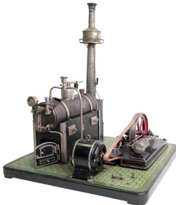
**3502** Bing liegende Dampfmaschine in besonderer Ausführung mit Speisepumpe und Dynamo und Manometer. Wasserreservoir im Kamin 45x45x55cm, Z2
