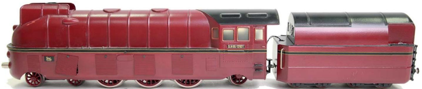
503 Berendt SLH66/12921 2C1 Schnellzuglok Stromlinienverkleidung mit Tender, rot, 20V Gleichstrom, L72cm, Z1-
