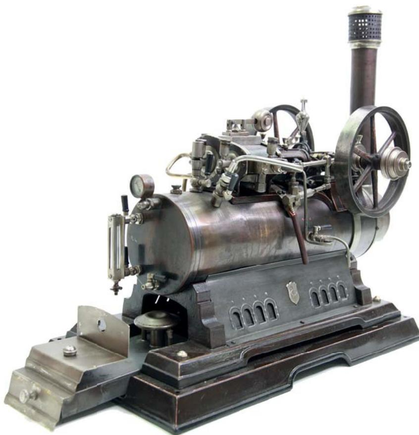
**8010** Märklin, 4127/4 stationäres Lokomobil, System Wolf, Compound Anordnung mit Hoch- und Niederdruckzylinder, Manometer und Sicherheitsventil, eine sehr seltene Dampfmaschine von 1904, L43cm, Z1-
