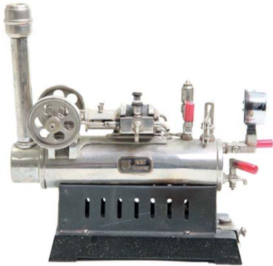
**8043** Märklin, 4801 Märklin Miniatur Lokomobil ‚Lilliput‘, vernickelte Ausführung, Compound Ausführung mit Hoch- und Niederdruckzylinder. Mit doppelt wirkenden Zylinder, Sicherheitsventil, Manometer und Dampfpeife. Gewicht am Sicherheitsventil fehlt. Selten 19x8x17cm Z1-2
