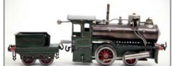
**244** Falk, 116R Storchenbein Spritusbetrieb, oszillierender Zylinder mit Dampfpeife und Sicherheitsventil, interessante Steuerung, V+R, L29cm, Z1-2
