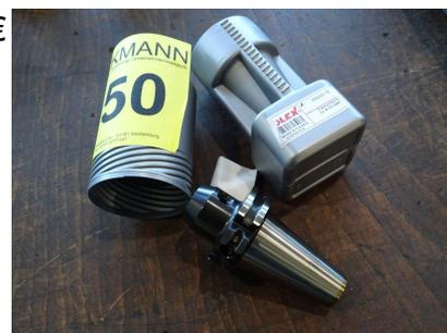
**51 Fräseraufnahme, Flächenspannfutter Form AD 10 mm HOLEX 5,00 €**
