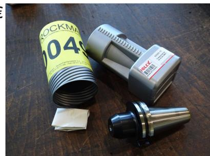
**50 Fräseraufnahme, Flächenspannfutter Form AD 10 mm HOLEX 5,00 €**
