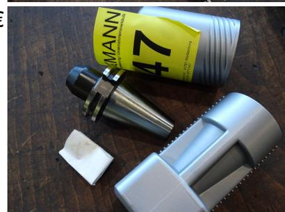
**48 Fräseraufnahme, Flächenspannfutter Form AD 10 mm HOLEX 5,00 €**
