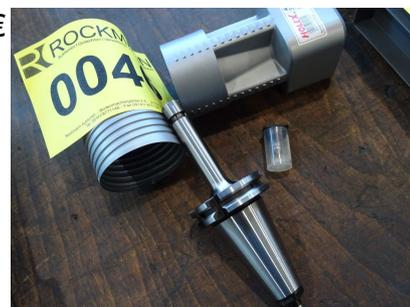
**47 Fräseraufnahme, Flächenspannfutter Form AD 10 mm HOLEX 5,00 €**
