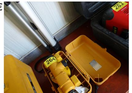
**265 automatisches Niveliergerät ZEISS NI 40**
