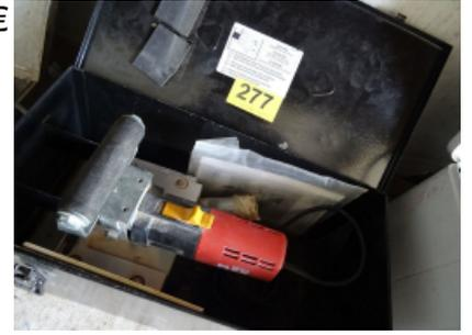
**278 Lötgerät für Installationsrohre REMS CONTACT 2000**
