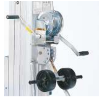
2-Gang Winde Größere Übersetzung für weniger Umdrehungen.
