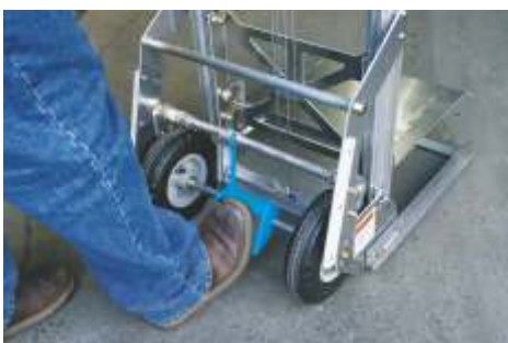
Feststellbremse zur Sicherung des Lifts gegen wegrollen
