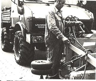
Hydraulikschläuche am Gehäuse und an den Halterungen lösen.
