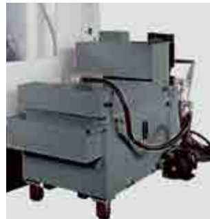
Bandfiltereinheit auf Kühlwassertank
