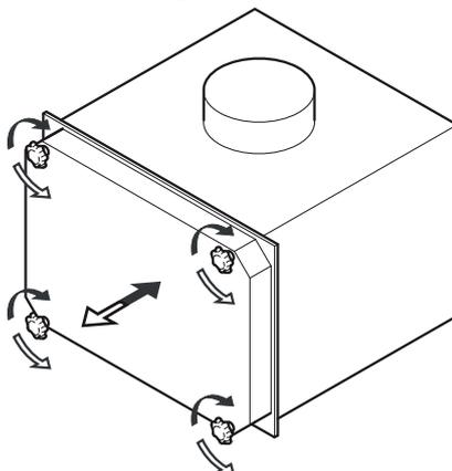
3. Bei Schwebstoff- und Abriebfilter die seitliche Anpressvorrichtung entriegeln.
