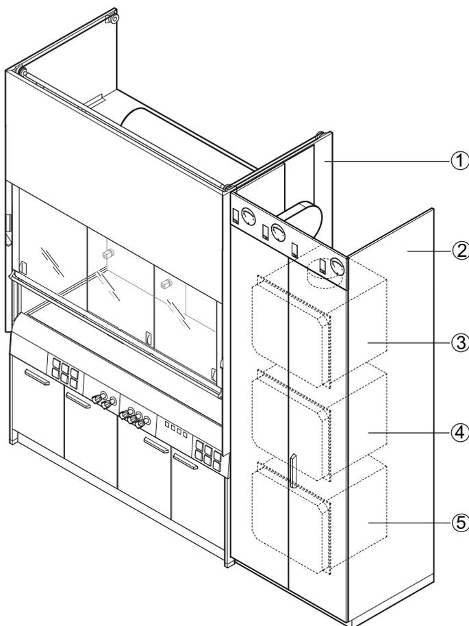
**Filterabzug mit Filterschrank und drei Filtern**
